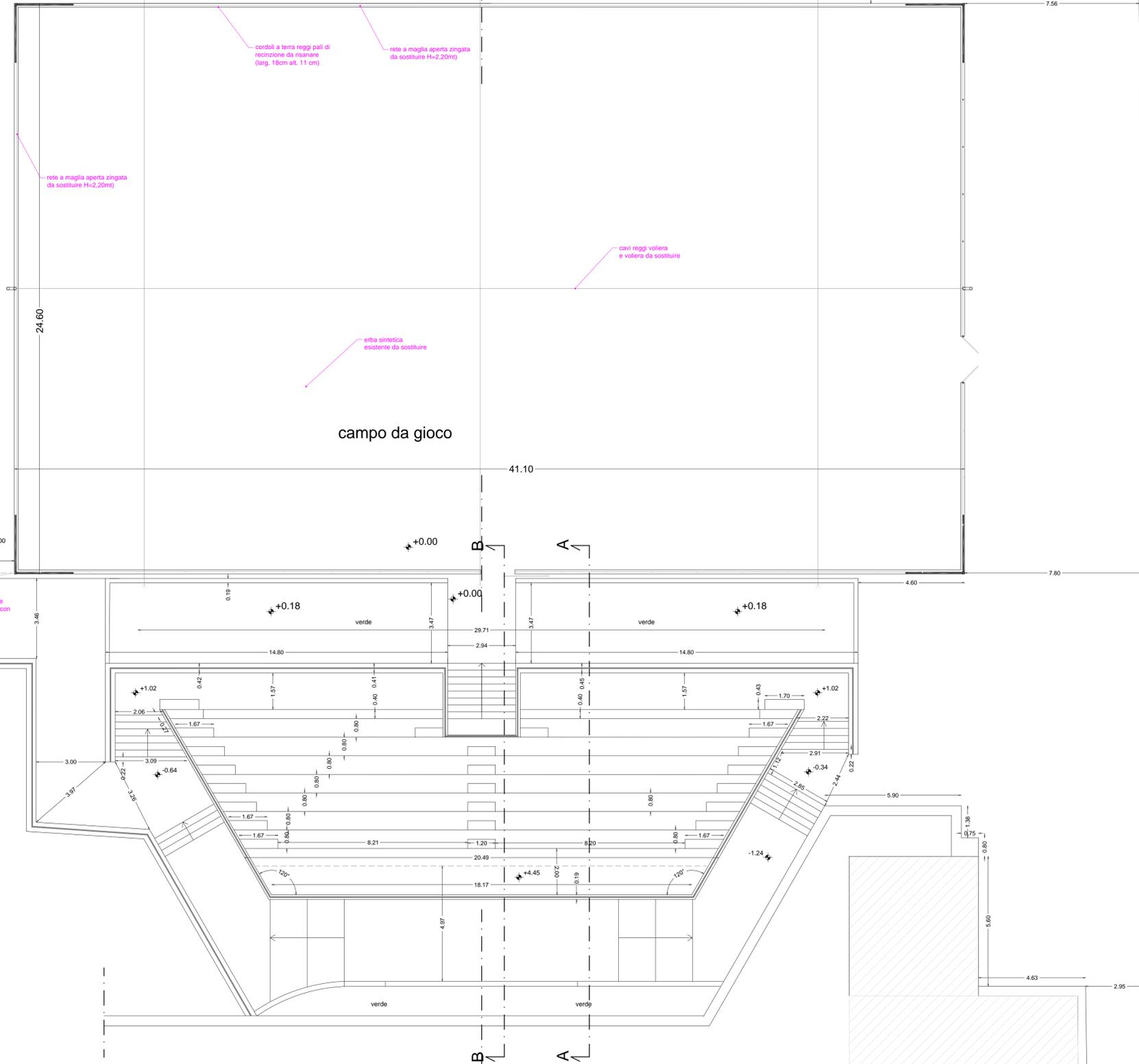
Continuo delle sedute esistenti in mattoni pressati e rifinitura delle sedute con mattoni pressati come esistente
